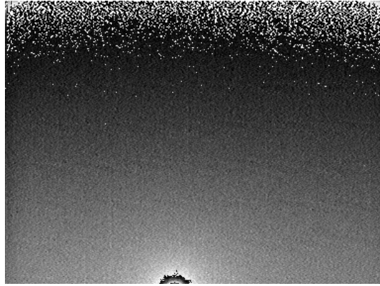
Abbildung 7: Dunkelsignal der CCD-Kamera. Die unterschiedlichen Signalintensitäten weisen auf eine ungleichmäßige Temperaturverteilung auf dem CCD-Chip hin.
